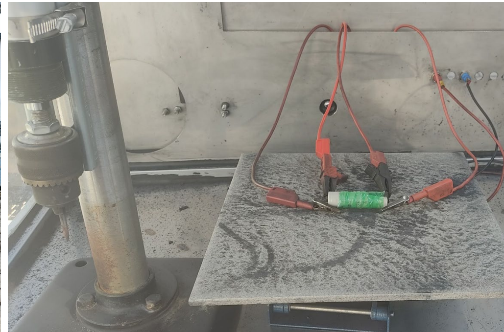
Testaufbau zum zerstörerischen Test einer Zelle
