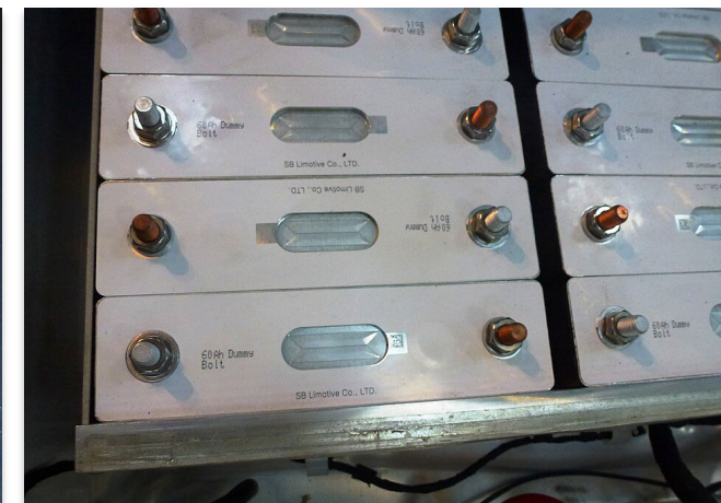
Mehrere Zellen im Batteriepack (BMW i3)
