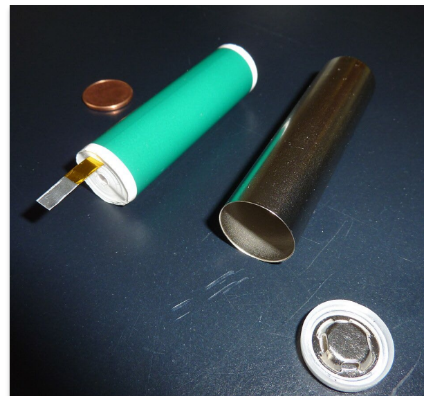
Zellkappe mit Venting-Rille (18650-Zelle)
