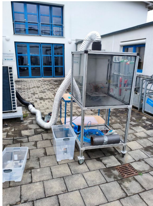
Testaufbau zum zerstörerischen Test einer Zelle
