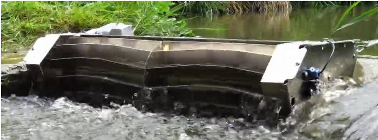
Abb. 1: Mobile Wasserkleinkraftanlage von Dipl.-Ing. Rudolf Keiluweit
