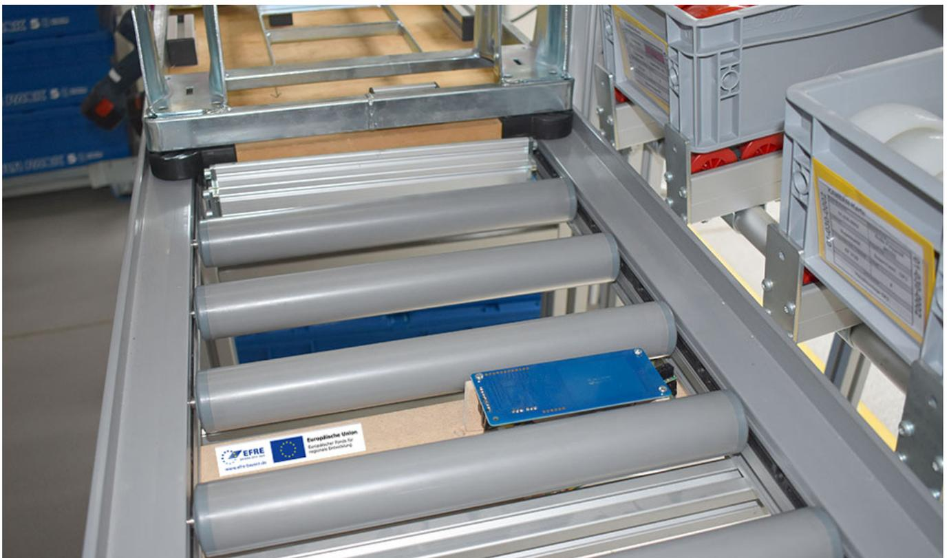
Abbildung 3: Unterhalb der Auflagefläche der Werkstückträger eingebaute Sensorik
