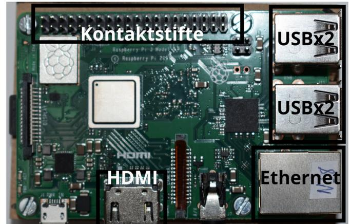
Abbildung 1: Der Einplatinencomputer Raspberry Pi 3b+ mit markierten Anschlüssen
