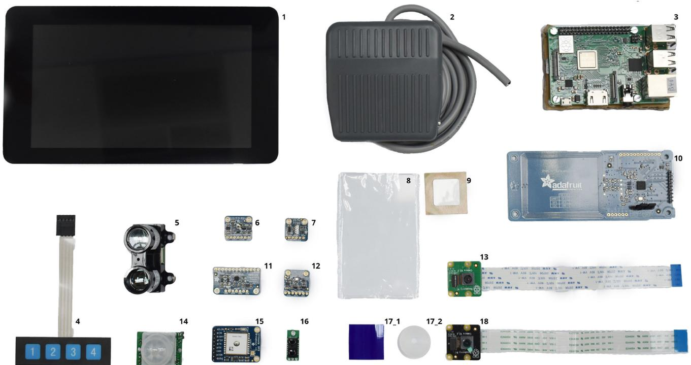
Abbildung 1: Ein Ausschnitt der verfügbaren mobilen Hardware: 1: 7 Zoll Touchscreen; 2: Fußstaster; 3: Raspberry Pi 3b+; 4: Druckknöpfe; 5: LIDAR; 6: Time of Flight Distanzsensor; 7: Lichtsensor; 8: RFID-Karte; 9: NFC-Aufkleber; 10: RFID-Sensor; 11: Kapazitiver Sensor; 12: Temperatur-, Druck- und Luftfeuchtigkeitssensor; 13: Raspberry Pi Kamera; 14: Bewegungsmelder; 15: GPS-Sensor; 16: Distanzsensor; 17: Kamerazubehör; 18: Nachtsichtkamera
