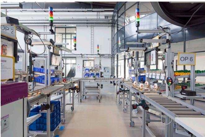
Abbildung 4: U-Zelle für die Endmontage von Bodenrollern
