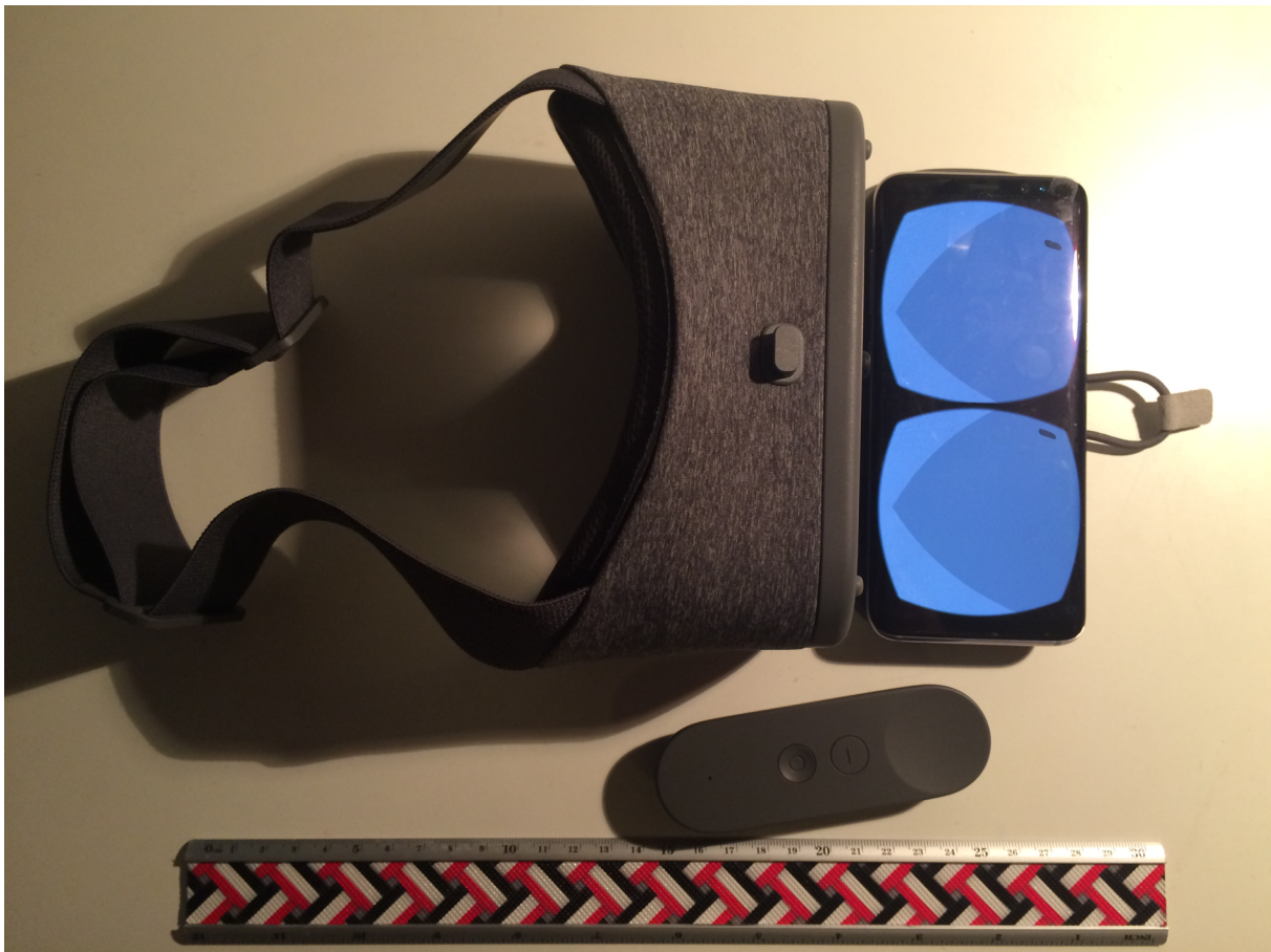
Abbildung 14: VR-Headset bestehend aus Daydream View und Samsung Galaxy S8 im Verhältnis zu einem 30 cm langen Lineal
