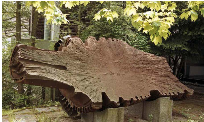
Bruchstück des Irschingrotors – 24t
