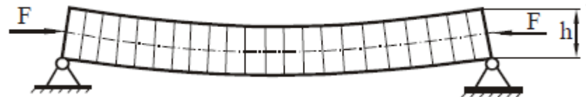
Globale Instabilität beim Sandwichbalken
