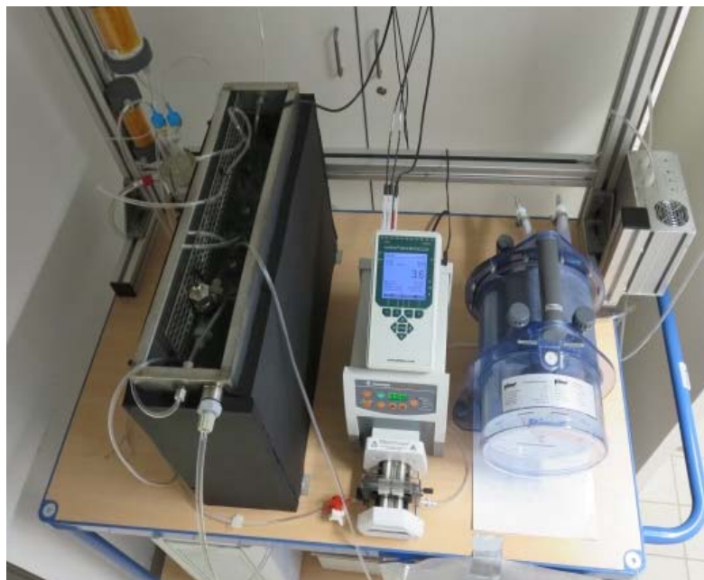
Abbildung 5: Versuchseinrichtung zur Gasreinigung (Ausschnitt) mit Adsorptionskolonnen im Wasserbad (links), Messgaskühler (hinten rechts) und Trocknungskolonnen (hinten links) (© ???)
