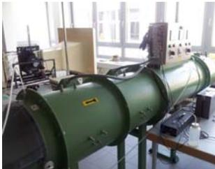
Das Ziel dieses Versuchs ist die Aufnahme des Kennfeldes eines Axialgebläses durch die Variation des Volumenstroms. Zudem soll der Wirkungsgrad des Axialgebläses bestimmt werden. Die Mengenummessung wird mit einer Normblende nach DIN 1952 durchgeführt. Das Verdichterkennfeld (Wirkdruck vs. Fördervolumen) und den Wirkungsgradverlauf (Wirkungsgrad vs. Fördervolumen) sollen für das Axialgebläse erfasst werden.
