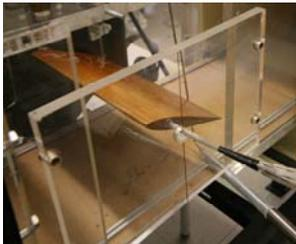
Das Ziel dieses Versuchs ist die experimentelle Bestimmung des aerodynamischen Widerstands- und Auftriebskraft und die Aufstellung der Lilienthal-Polare eines NACA 0012 Profils.
