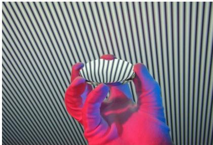
Phasenmessende Deflektometrie („PMD“) ist ein etabliertes Messverfahren zur hochgenauen Vermessung der Topographie spiegelnder Oberflächen. Das Verfahren beruht auf der Reflexion bekannter (in der Regel sinusförmiger) Muster und Mustersequenzen am zu vermessenden Objekt. Da diese Messtechnik sowohl neigungssensitiv als auch inkohärent ist, können Höhenvariationen im Bereich weniger hundert Nanometer robust und zuverlässig erkannt werden – und dies sogar im industriellen Umfeld.
