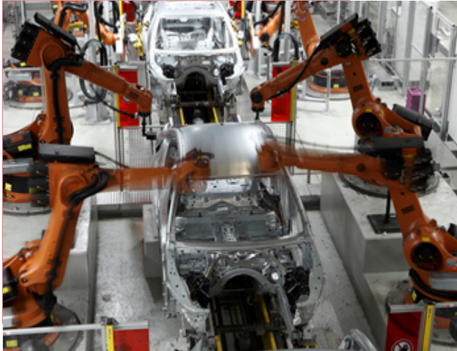
Die Schweißroboter des BMW-Werks 2.4 am Standort Dingolfing
