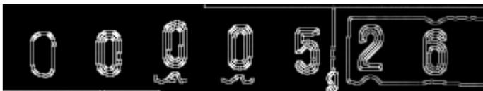
Abb. 6: Kantenverstärkung mit Sobelfilter
