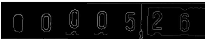
Abb. 5: Kantenbild mit Canny-Algorithmus
