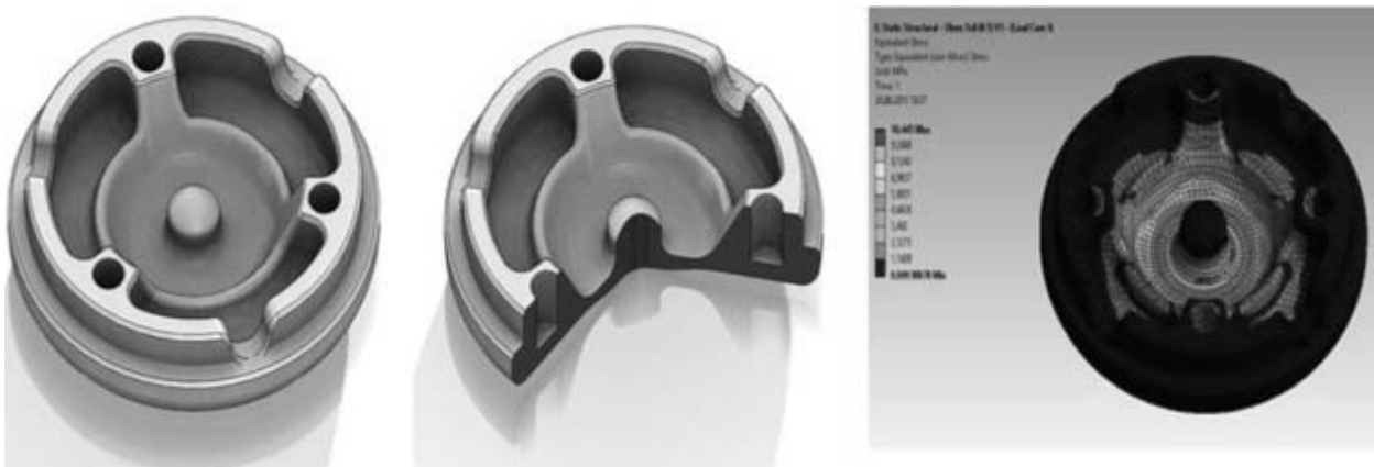
Abb. 8: Exemplarisch ein Entwicklungsschritt des Gehäuses. Rechts ist die Berechnung der Druckverteilung zu sehen.
