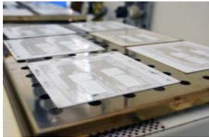
Die Displays werden Schicht für Schicht auf eine Trägerfolie gedruckt. Zwischen den Schritten müssen sie trocknen.
