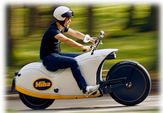
Abbildung 2: Johammer J1, Elektromotorrad mit Miba Battery Systems Akku
